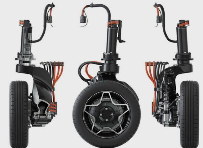
No E-corner os componentes da propulsão e do chassi são agrupados em um módulo composto por motor elétrico montado no cubo da roda; suspensão; e atuador para a direção eletromecânica
